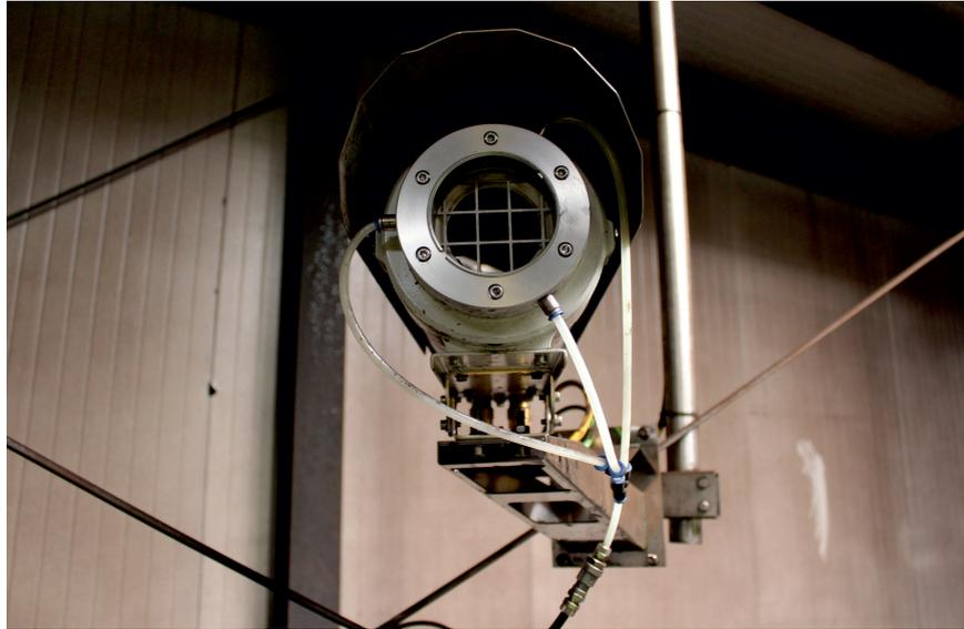
und Hauptalarm sind in den Systemen hinterlegt und die Kameras sind über ein Netzwerk mit einem Embedded-PC verbunden, der die Daten über MODBUS der Leitwarte zur Verfügung stellt. Hier sind alle Livebilder der Kameras inklusive Trendanzeigen auf einem Monitor zu sehen (Bild 3).
